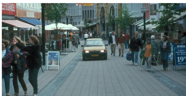
Obrázek 8: Vydlážděné pásy upozorňují vizuálně i akusticky řidiče v místech, kde musejí zvýšit pozornost. Vibrace a hluk mohou snížit snížením rychlosti. / Zdroj: https://www.pps.org/article/livememtraffic
